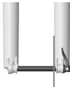
EJE INSTALADO CORRECTAMENTE
