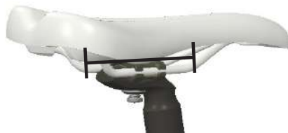
SECTION DROITE DES RAILS DE SELLE
