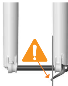
EIXO INSTALADO INCORRETAMENTE
