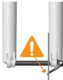
ONJUIST GEÏNSTALLEERDE AS
