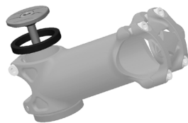
ATTACCO MANUBRIO, DISTANZIALE E TERMINALE SUPERIORE
