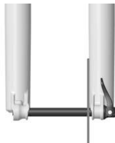
AXE CORRECTEMENT INSTALLÉ
