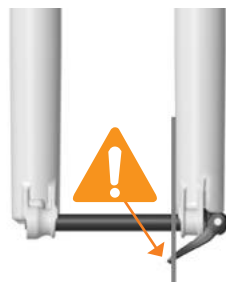
AXE INSTALLÉ DE MANIÈRE INCORRECTE
