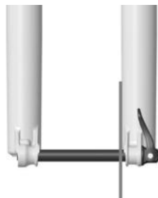
AXE CORRECTEMENT INSTALLÉ
