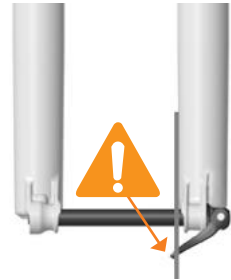
AXE INSTALLÉ DE MANIÈRE INCORRECTE
