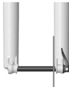
PERNO INSTALLATO CORRETTAMENTE
