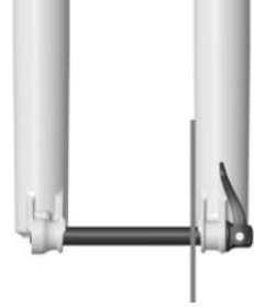
AXE CORRECTEMENT INSTALLÉ
