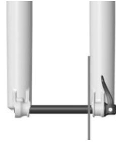
EJE INSTALADO CORRECTAMENTE
