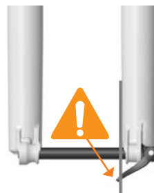
PERNO INSTALLATO IN MODO ERRATO
