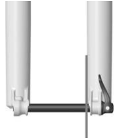
RICHTIG MONTIERTE ACHSE
