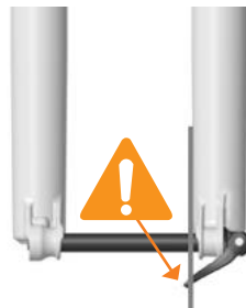
EIXO INSTALADO INCORRETAMENTE
