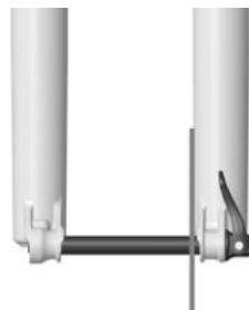
EJE INSTALADO CORRECTAMENTE
