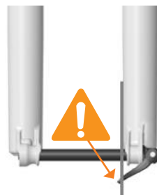
EJE INSTALADO INCORRECTAMENTE
