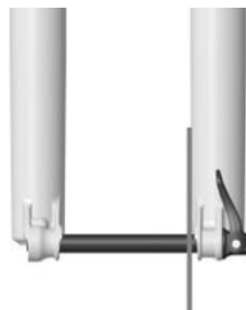
EIXO INSTALADO CORRETAMENTE
