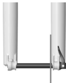
AXE CORRECTEMENT INSTALLÉ
