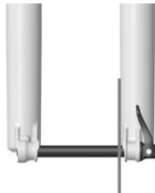
PRAWIDŁOWO ZAMONTOWANA OŚ
