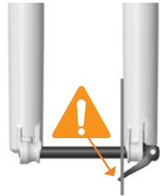
FALSCH MONTIERTE ACHSE
