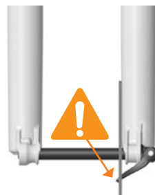
EJE INSTALADO INCORRECTAMENTE
