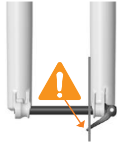
AXE INSTALLÉ DE MANIÈRE INCORRECTE
