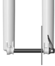
AXE CORRECTEMENT INSTALLÉ
