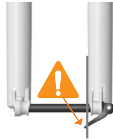
EIXO INSTALADO INCORRETAMENTE
