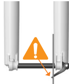
ONJUIST GEÏNSTALLEERDE AS
