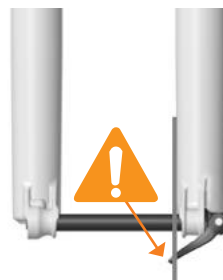
PERNO INSTALLATO IN MODO ERRATO
