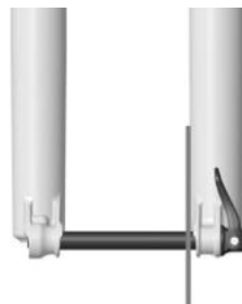
PERNO INSTALLATO CORRETTAMENTE
