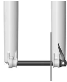
EJE INSTALADO CORRECTAMENTE
