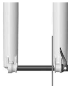
EJE INSTALADO CORRECTAMENTE
