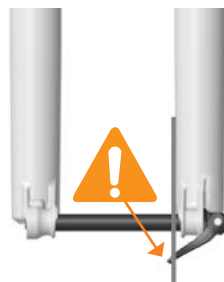
NIEPRAWIDŁOWO ZAMONTOWANA OŚ
