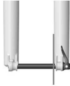
RICHTIG MONTIERTE ACHSE
