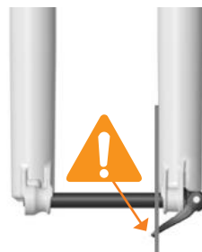
EIXO INSTALADO INCORRETAMENTE
