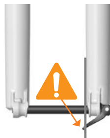
PERNO INSTALLATO IN MODO ERRATO
