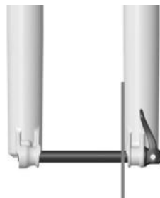
AXE CORRECTEMENT INSTALLÉ
