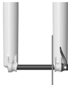
EIXO INSTALADO CORRETAMENTE
