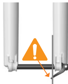
AXE INSTALLÉ DE MANIÈRE INCORRECTE
