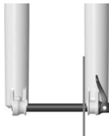
PERNO INSTALLATO CORRETTAMENTE
