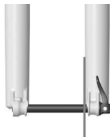
AXE CORRECTEMENT INSTALLÉ
