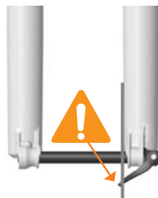
PERNO INSTALLATO IN MODO ERRATO
