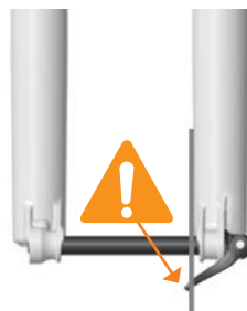
PERNO INSTALLATO IN MODO ERRATO
