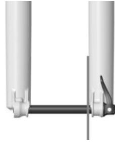
RICHTIG MONTIERTE ACHSE
