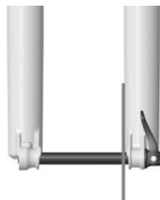
EJE INSTALADO CORRECTAMENTE
