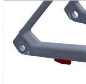
Rear derailleur cable stop
