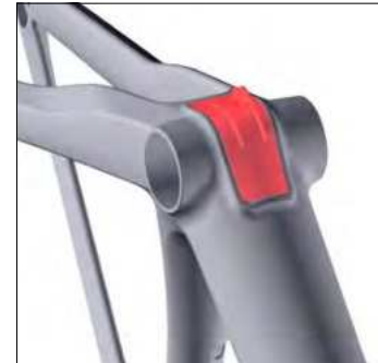
Rear derailleur cable stop
