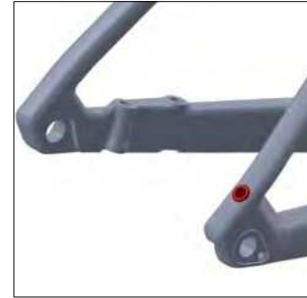
Rear derailleur cable exit
