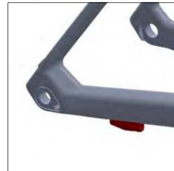
Rear derailleur cable stop
