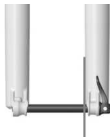
AXE CORRECTEMENT INSTALLÉ
