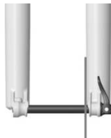
EJE INSTALADO CORRECTAMENTE
