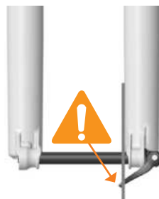
ONJUIST GEÏNSTALLEERDE AS
