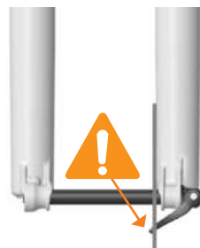
AXE INSTALLÉ DE MANIÈRE INCORRECTE
