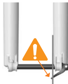
EJE INSTALADO INCORRECTAMENTE
