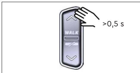
Fig. 9: Activation de l'assistance à la poussée
