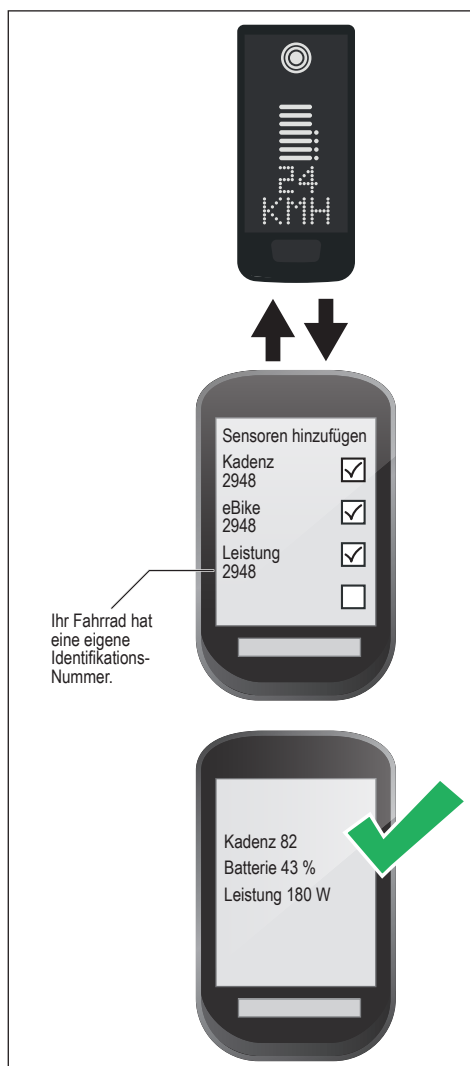
Abb. 8: Verbindung E-Bike zu Fahrradcomputer
