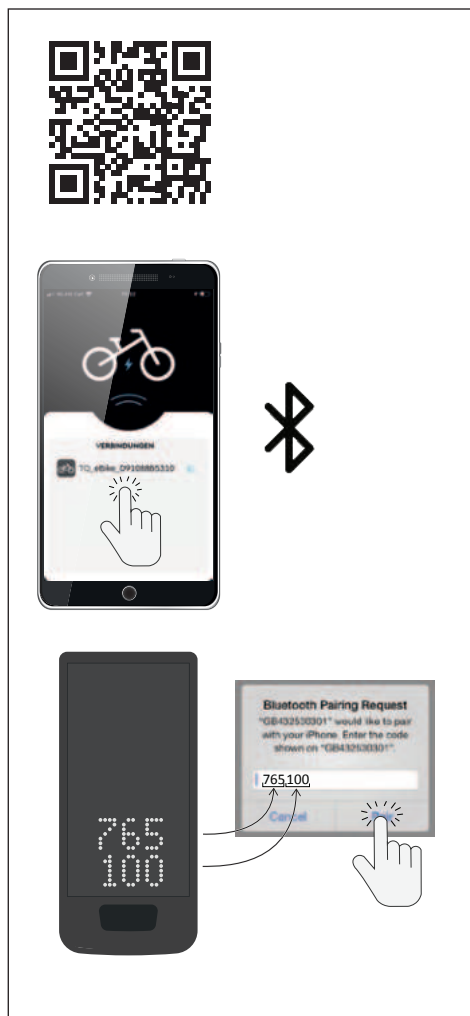
Fig. 7: Connexion de l'e-bike au smartphone
