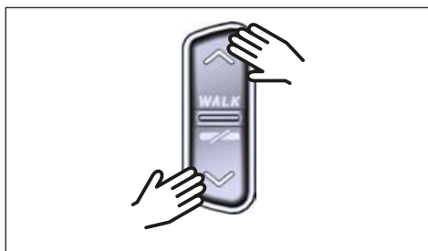
Fig. 6: Sélection du niveau d'assistance sur la Remote
