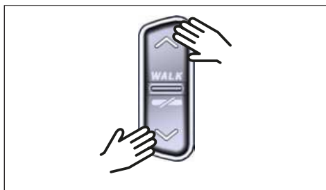
Fig. 6: Selezione del livello di supporto sul Remote
