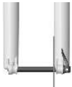
AXE CORRECTEMENT INSTALLÉ
