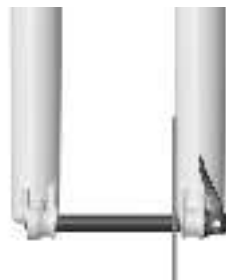
EIXO INSTALADO CORRETAMENTE
