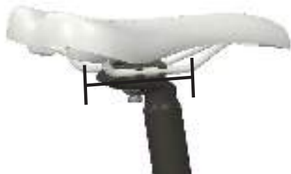
GERADER ABSCHNITT DER SATTELSTREBEN
