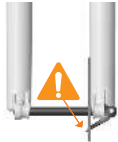
FALSCH MONTIERTE ACHSE
