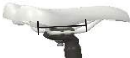
RECHT GEDEELTE VAN DE ZADELRAILS
