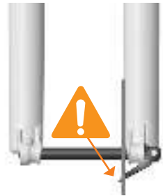
FALSCH MONTIERTE ACHSE
