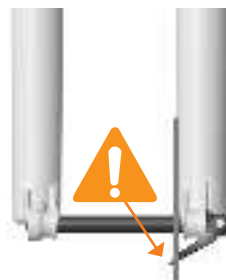
ONJUIST GEÏNSTALLEERDE AS
