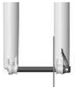
EJE INSTALADO CORRECTAMENTE
