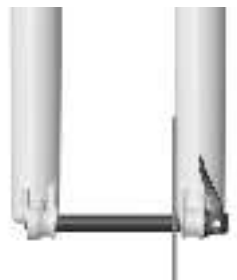
AXE CORRECTEMENT INSTALLÉ
