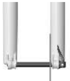
EJE INSTALADO CORRECTAMENTE
