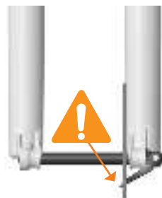
AXE INSTALLÉ DE MANIÈRE INCORRECTE
