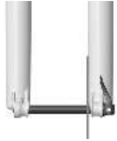
RICHTIG MONTIERTE ACHSE
