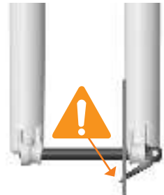
ONJUIST GEÏNSTALLEERDE AS
