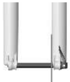
AXE CORRECTEMENT INSTALLÉ
