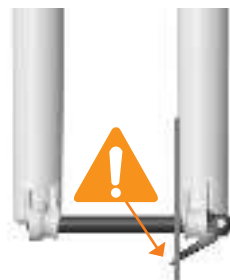
AXE INSTALLÉ DE MANIÈRE INCORRECTE
