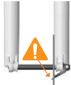
ONJUIST GEÏNSTALLEERDE AS
