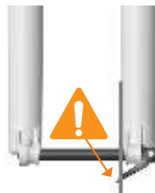
EIXO INSTALADO INCORRETAMENTE
