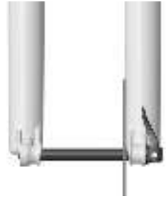
RICHTIG MONTIERTE ACHSE
