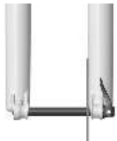
EIXO INSTALADO CORRETAMENTE
