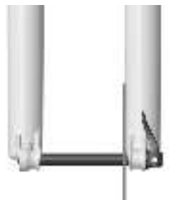
AXE CORRECTEMENT INSTALLÉ
