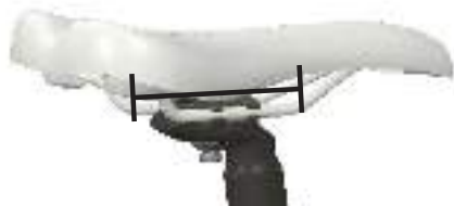
RECHT GEDEELTE VAN DE ZADELRAILS
