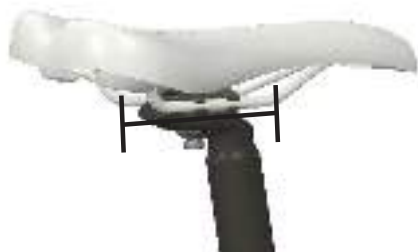
GERADER ABSCHNITT DER SATTELSTREBEN
