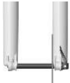
PRAWDŁOWO ZAMONTOWANA OŚ
