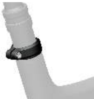
COLLARINO REGGISSELLA A VITE DI TIPO FISSO
