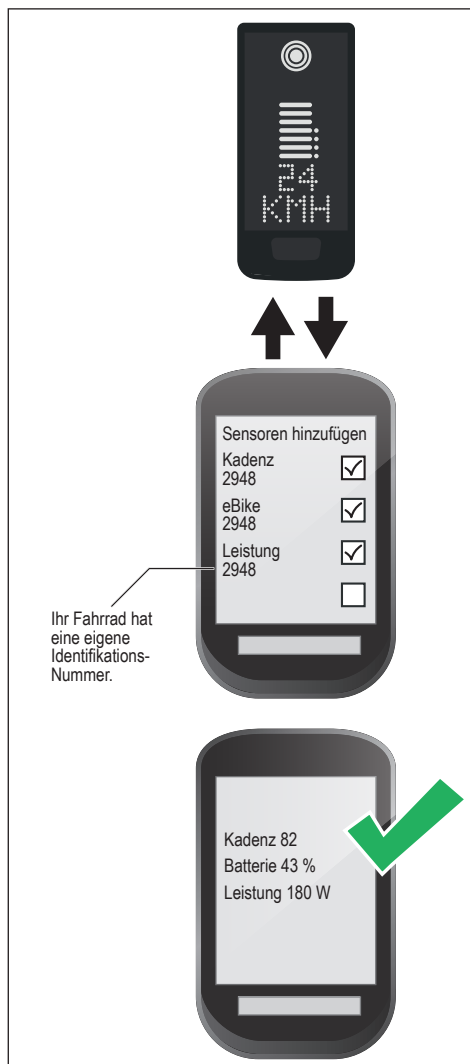
Abb. 8: Verbindung E-Bike zu Fahrradcomputer
