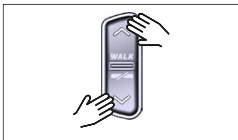
Fig. 6: Sélection du niveau d'assistance sur la Remote
