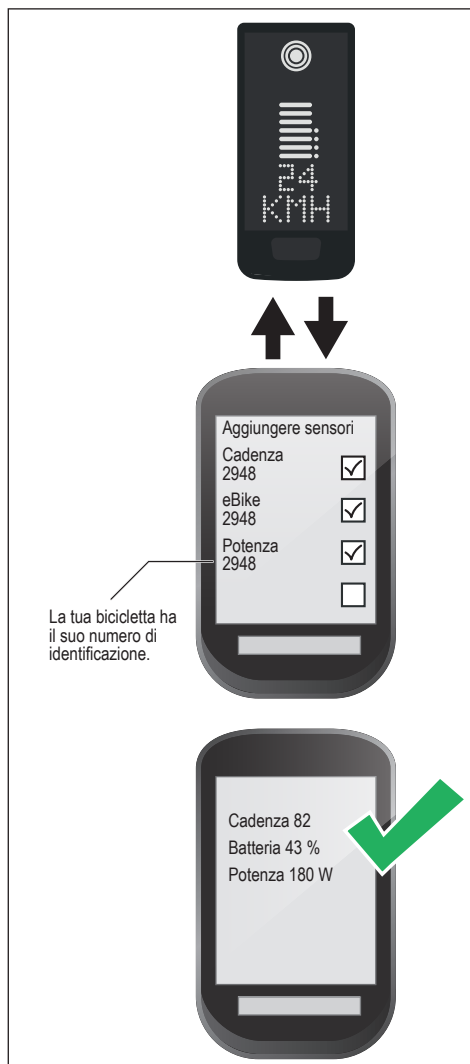
Fig. 8: Connessione e-Bike al ciclocomputer
