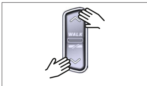
Fig. 6: Selezione del livello di supporto sul Remote
