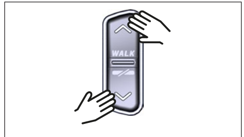
Abb. 6: Unterstützungsstufe an der Remote wählen
