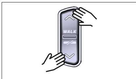
Fig. 6: Selezione del livello di supporto sul Remote
