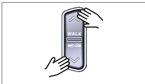
Fig. 6: Selección del nivel de soporte en el Remote
